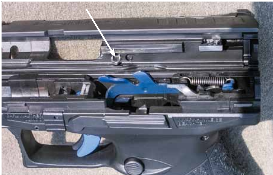
» Modré táhlo spouště má dva tvarované výstupky, z nichž jeden slouží pro deaktivaci blokace úderníku, druhý funguje jako přerušovač spouště. Šipka označuje váleček blokující úderník.
