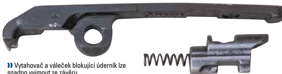
» Modré táhlo spouště má dva tvarované výstupky, z nichž jeden slouží pro deaktivaci blokace úderníku, druhý funguje jako přerušovač spouště. Šipka označuje váleček blokující úderník.
