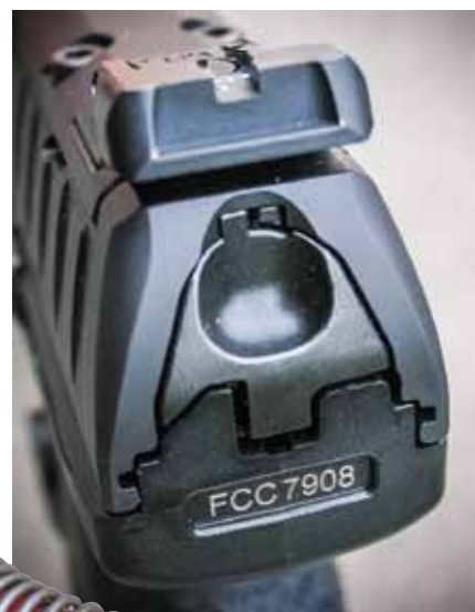
» ...a obdobně snadno a rychle lze vyjmout sestavu úderníku s bicí pružinou – pouhým otevřením víčka na zadní straně závěru
