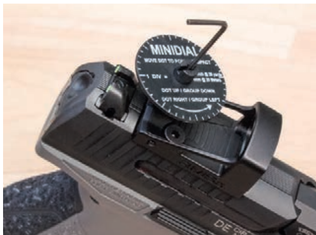
■ Korekce kolimátoru v obou rovinách se provádí pomocí dvou šroubků
