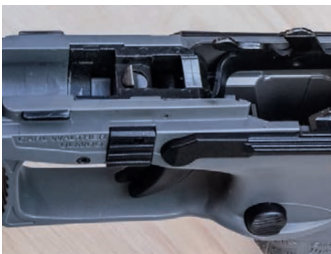
■ Křídélka pro vedení závěru má PPQ zalisována do plastového těla
