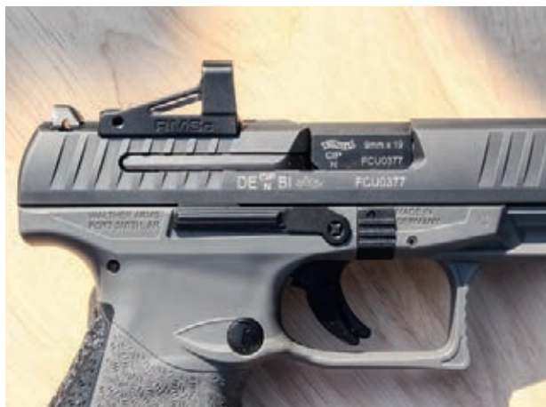
■ Kolimátor je připevněn do vyfrézované části přímo na tělo závěru
