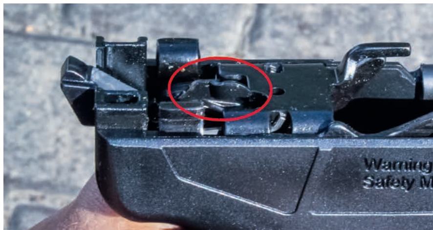
■ Pístek blokující úderník se zvedá krátkým rotačním pohybem páčky, spřažené s táhlem spouště
