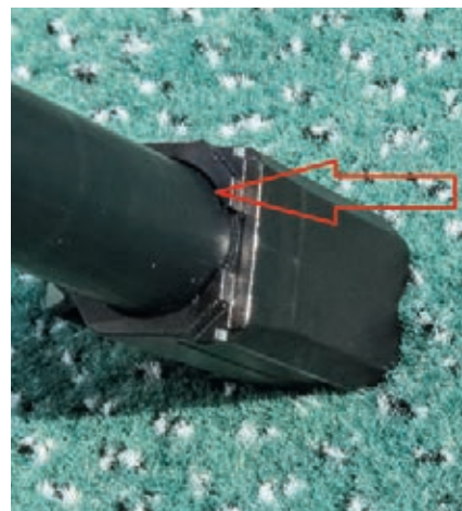
■ Dá se usuzovat, že hranol na konci hlavně je samostatný díl, do něhož je vsazena čisté válcová hlaveň
