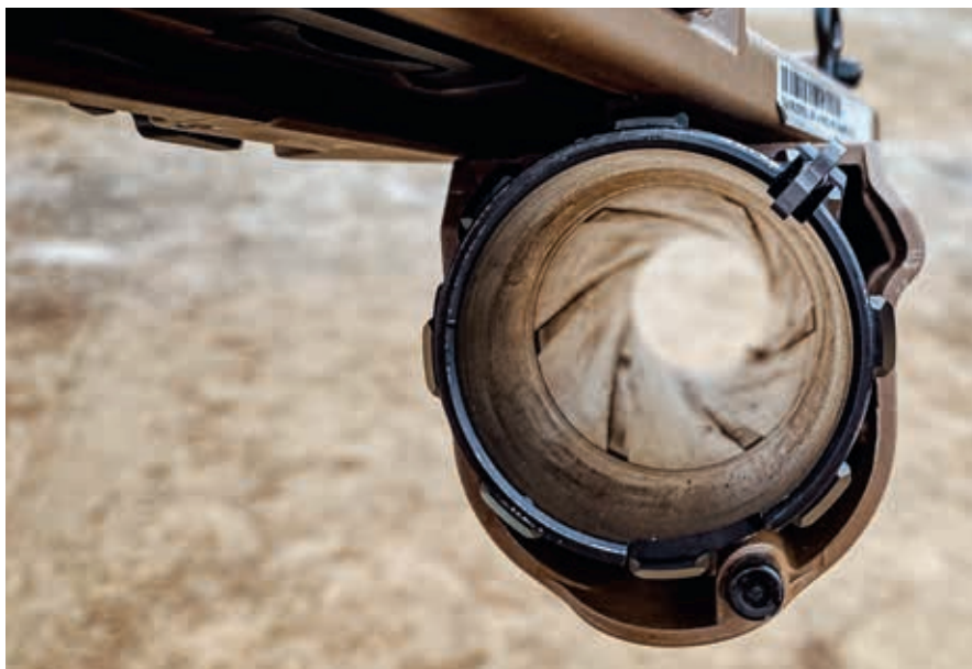
Komora a vývrt podvážného granátometu FN40GL Mk2. Hlaveň je naplno otevřena a otočena doprava.
