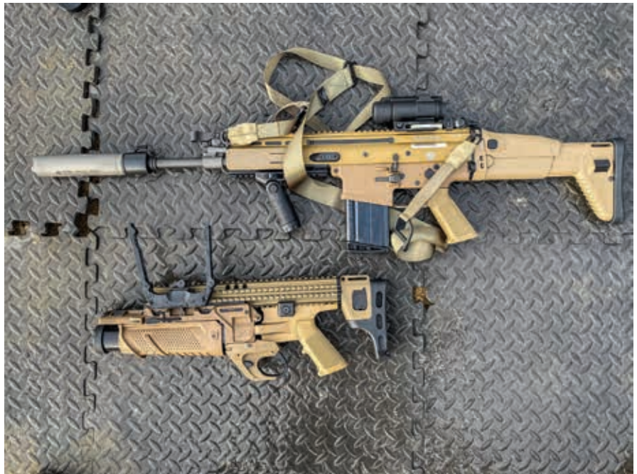
Puška FN SCAR CQC s 330mm hlavní, tlumičem Rotex V a kolimátorem Aimpoint Comp M4, dole stand-alone granátomet FN40GL Mk2
