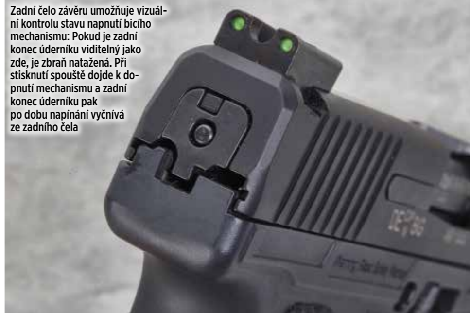
PPS M2 má specificky tvarované výhozni okénko s výrazně zkosenou přední hranou, k uzamčení hlavně a závěru nicméně slouží skrytá vnitřní hrana okénka kolmá na osu zbraně
