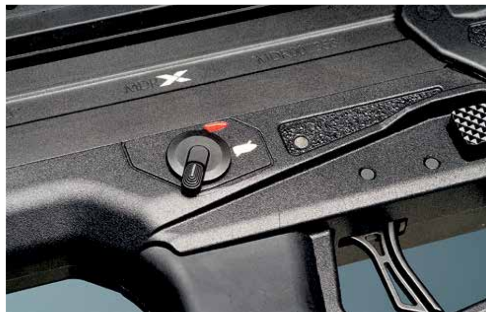
Pojistka v tomto případě plní pouze funkci k zajištění či odjištění zbraně, u plně samočinné verze bude ještě poloha pro strelbu dávkou
