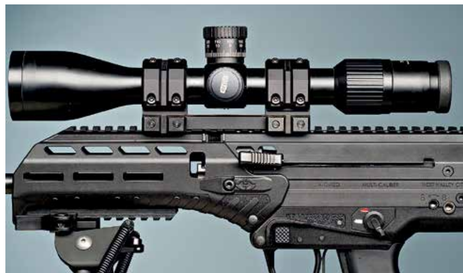
Pokud je na zbrani instalována nějaká větší optika, bohužel se nelze vyhnout uložení montáže jak na těle zbraně, tak na předpažbí
